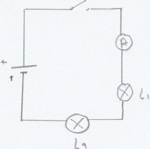
4. Brancher l'appareil pour mesurer l'intensité du courant qui sort de la pile (le courant doit rentrer par la borne 10 A).
